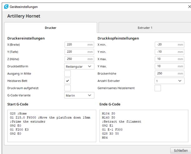
Stellen Sie **X (Breite)**, **Y (Tiefe)** auf **220**, **Z (Höhe)** auf **250** ein. Stellen Sie sicher, dass **Heizbares Bett** aktiviert ist, und kopieren Sie den Inhalt von **Start G-code.txt** und **End G-code.txt** auf der Speicherkarte in die entsprechenden Felder.
