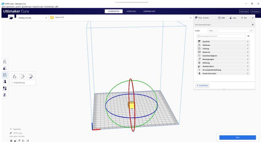
Ziehen Sie die STL-Datei (oder andere unterstützte Formate) per Drag & Drop in den Slicer oder laden Sie die Modelldatei mit **Datei** -> **Dateien öffnen...** und klicken Sie dann auf die Schaltfläche **Slice**.
